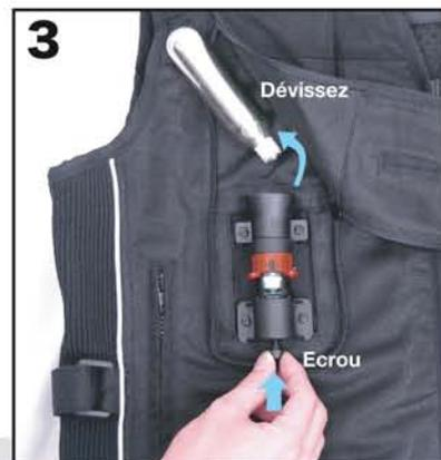
Insérez la clé imbus dans le socle de la cartouche et dévissez d'abord la cartouche à la main. Ensuite, continuer à dévisser l'écrou avec la clé imbus. Cette opération libère partiellement la cage de la bille d'acier (key ball).
