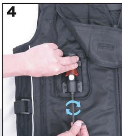
Continuer à dévisser l'écrou jusqu'à ce que la cage de la bille d'acier viennent se placer au centre du socle de la cartouche.
